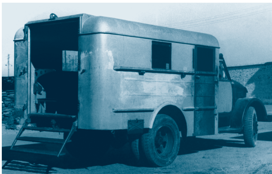
Nadwozie sanitarki N-243 zamontowane na podwoziu samochodu Lublin 51 – widok z tyłu
