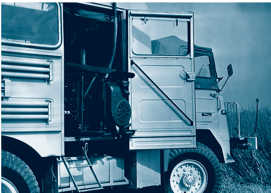
Agregat prądowórczy umieszczony przy bocznych drzwiach nadwozia warsztatu Jelcz 574 Z
