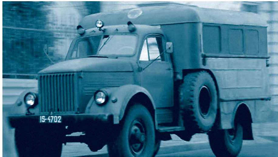
Nadwozie sanitarki N-444 zamontowane na podwoziu samochodu GAZ-63 z napędem 4×4
