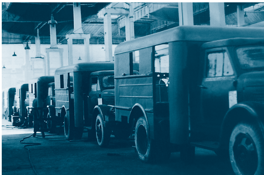
Montaż nadwozi sanitarek na podwoziach samochodów Lublin 51
