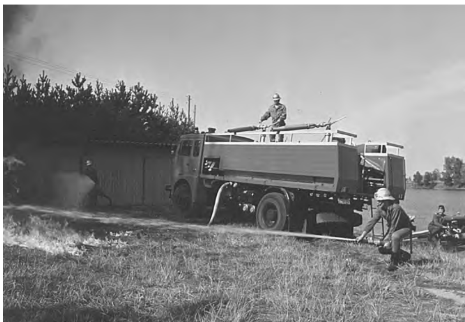
Prototyp samochodu pożarniczego Jelcz 004 podczas prób stanowiskowych
