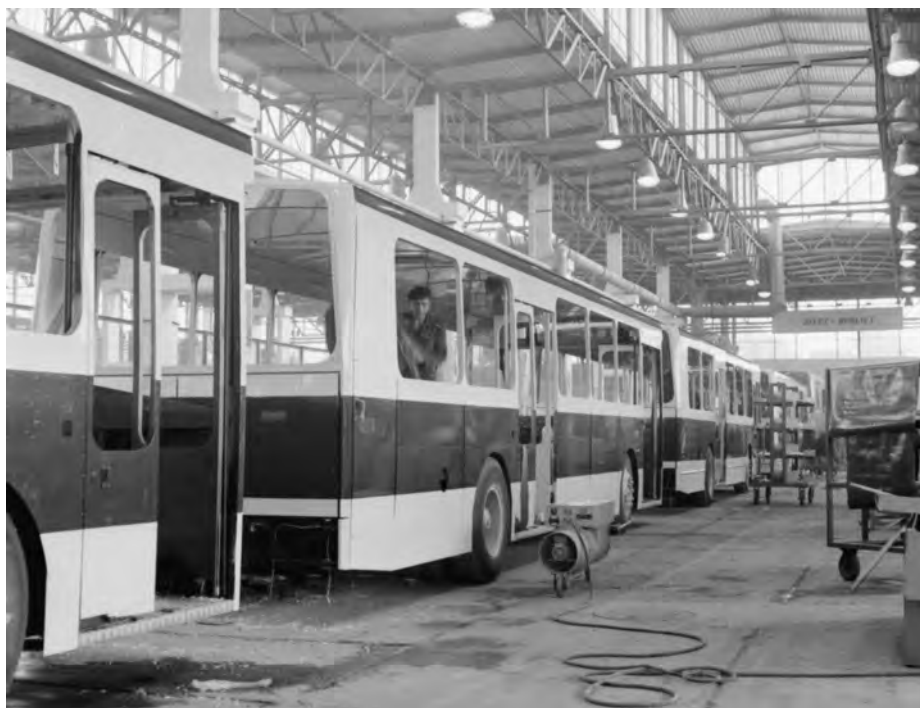
Prace przy tylnej części autobusów miejskich Jelcz Berliet PR 100 na pasie montażowym JZS
