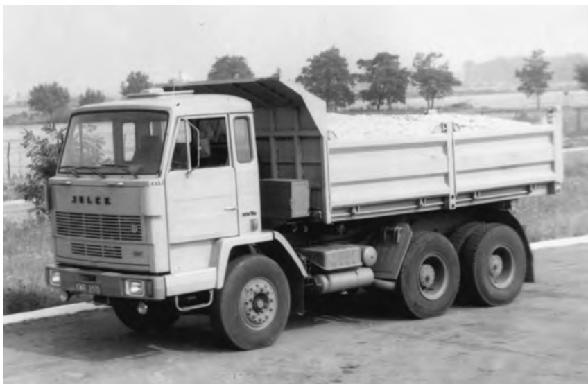
Prototyp samochodu samowyładowczego Jelcz W 641 z kabiną kierowcy typu 136 V – widok z lewej strony
