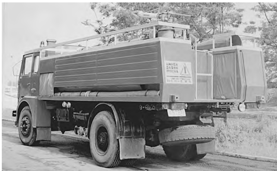
Samochód pożarniczy Jelcz 004 wyposażony w dwa działka Rosenbauer typu RM 16 o wydajności 1600 l/min
