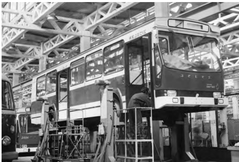
Prace przy przedniej części autobusów miejskich Jelcz Berliet PR 100 na pasie montażowym JZS
