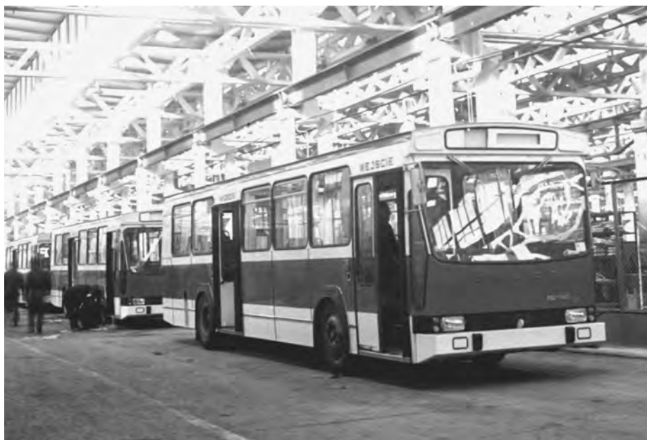
Końcowy montaż w JZS autobusów miejskich Jelcz Berliet PR 100
