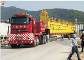
Rys. 1.10 Ciągniki balastowe Nicolas Tractomas ze specjalnymi przyczepami do przewozu ładunków ponadgabarytowych [217]
