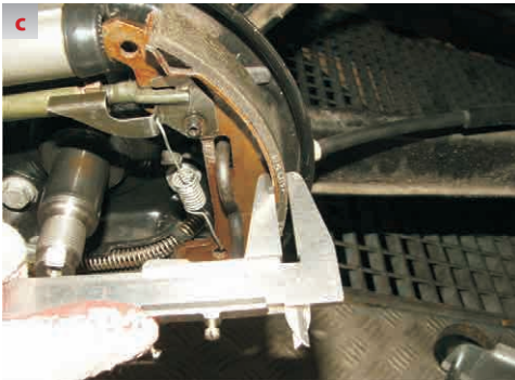
Rys. 7.3 Pomiary średnicy wewnętrznej bębna hamulca w dwóch wzajemnie prostopadłych płaszczyznach (a, b) oraz grubości okładziny szczęki hamulcowej jako różnicy wymiarów z rysunków (c) i (d) [Źródło: J. Kupiec]
