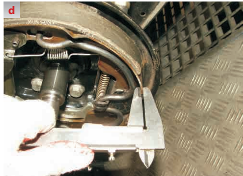
Rys. 7.3 Pomiary średnicy wewnętrznej bębna hamulca w dwóch wzajemnie prostopadłych płaszczyznach (a, b) oraz grubości okładziny szczęki hamulcowej jako różnicy wymiarów z rysunków (c) i (d) [Źródło: J. Kupiec]
