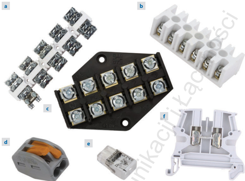
Rys. 1.11 Osrzęty wykorzystywane do łączenia przewodów a – listwa zaciskowa z nakładkami dociskany dwoma śrubami, b – listwa z zaciskami tulejkowymi, c – płytka z zaciskami z podkładką wahlwią, d – szybkozłączka z zaciskami dociskanymi dźwignienkami, e – szybkozłączka sprężynowa, f – złączka przeznaczona do montażu na szynę DIN
