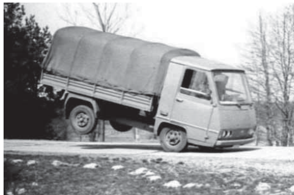
Prototyp następcy Żuka podczas próby hamowania Fot. archiwum PIMOT
