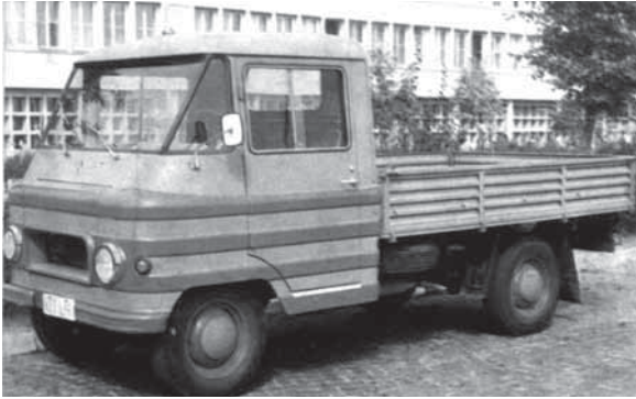
Żuk A-11 prototyp ze stalową skrzynią ładunkową Fot. archiwum FSC
