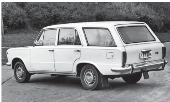
Polski Fiat 125p prototyp II o większej przestrzeni bagażnika opracowany według założeń strony polskiej. Po lewej wersja z boczną tylną szybą o innym kształcie, po prawej model najbardziej zbliżony do odmiany seryjnej. Widoczny inny sposób oświetlenia tablicy rejestracyjnej wbudowanego w uchwyt do otwierania kłapy bagażnika Fot. archiwum Muzeum Techniki w Warszawie
