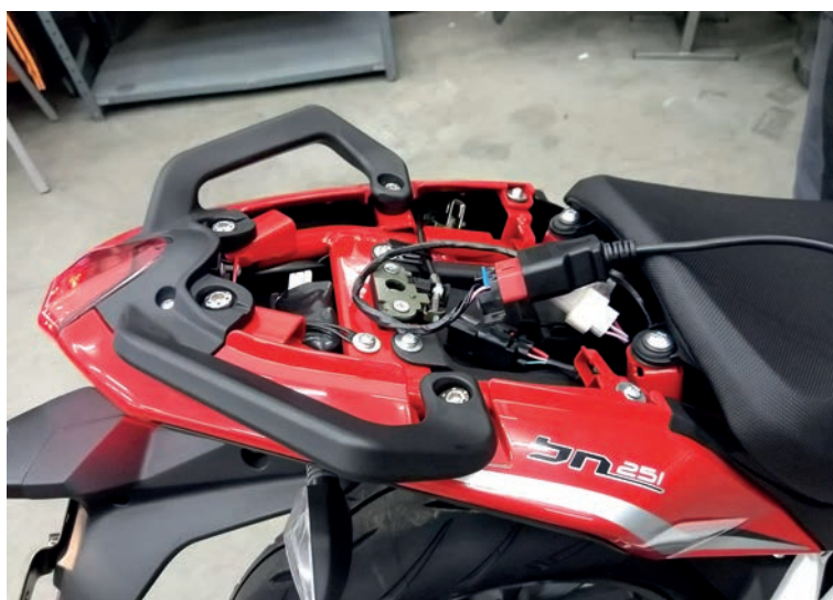
Rys. 3.1 Wtyczka diagnostoskopu podłączona do złącza diagnostycznego w motocyklu
