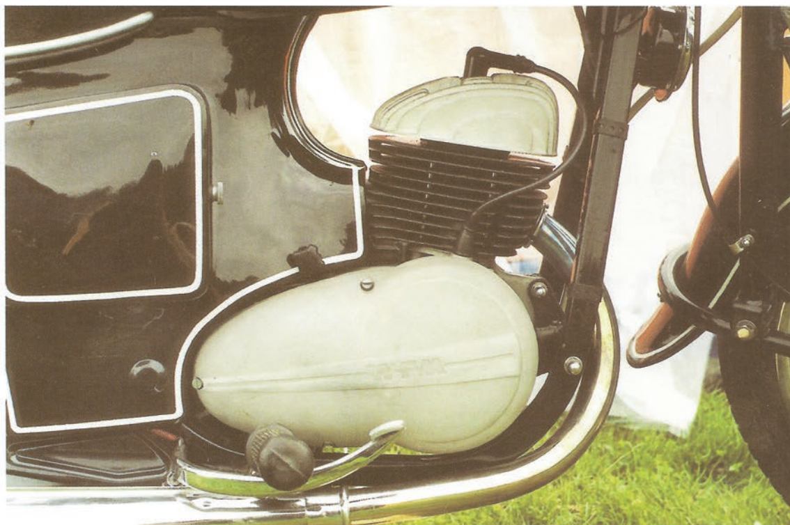
Zespół napędowy motocykla SHL M11 SHL M11 motorcycle power unit
