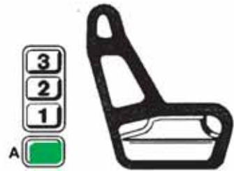
Rys. 1.33. Zespół przycisków do zmiany ustawienia fotela [18] A – przycisk pamięci do zapisywania ustawień fotela
