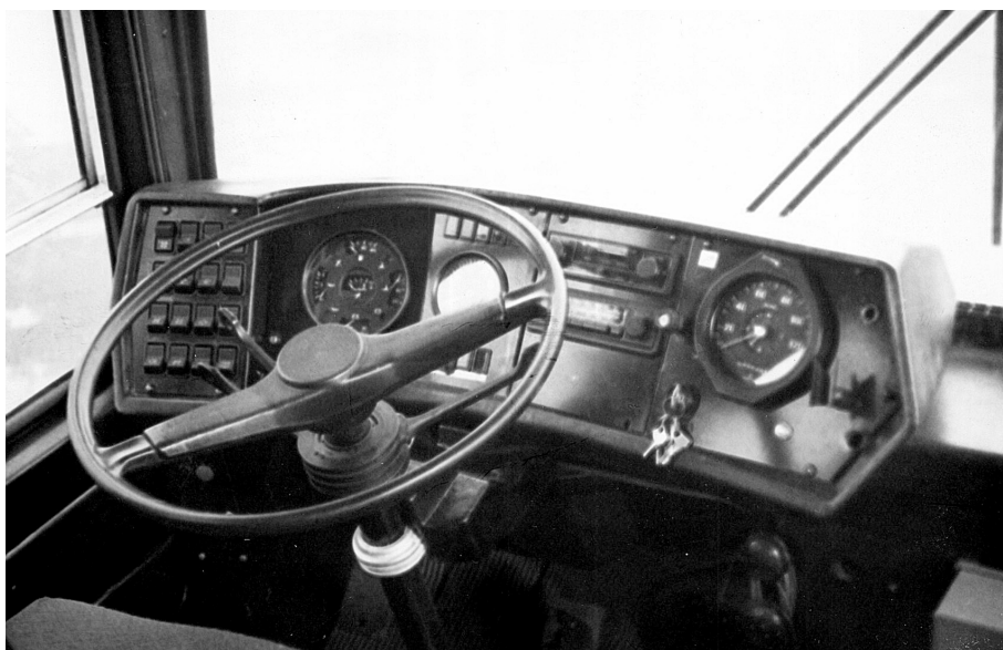
Stanowisko kierowcy w autobusie dalekobieżnym Jelcz PR 110 D
