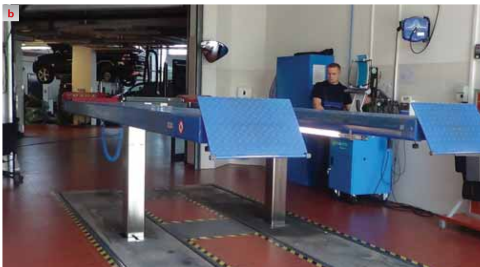
Rys. 1.6 Podnośnik podpodłogowy (kasetowy) w pozycji spoczynkowej (a) i roboczej (b)
