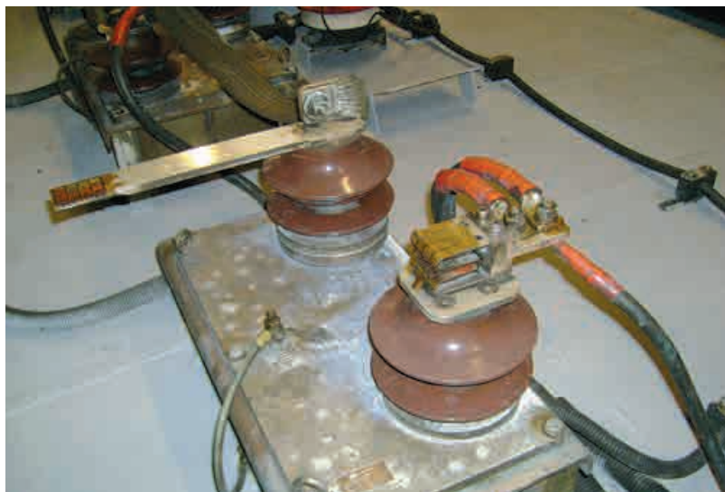
Rys. 3.7. Odłącznik pantografu z napędem w nowoczesnym taborze
