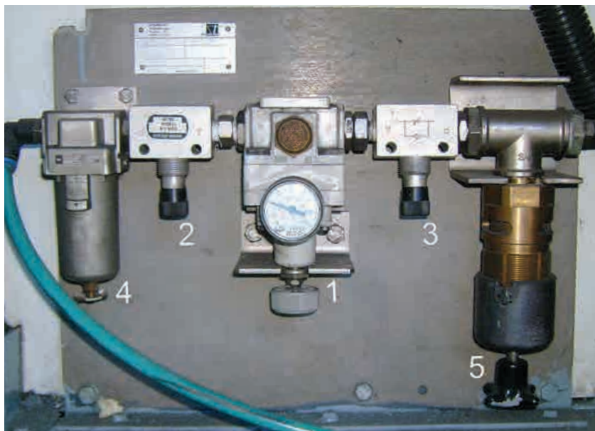
Rys. 3.4. Tablica sterująca pantografu
