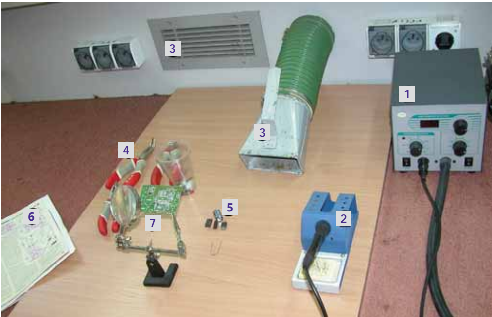
Rys. 1.4 Przykładowe rozmieszczenie przyrządów i narzędzi na stanowisku pracy 1 – stacja lutownicza, 2 – lutownica z podstawką, 3 – system wentylacji stanowiska pracy, 4 – narzędzia, 5 – elementy elektroniczne, 6 – dokumentacja układu elektronicznego, 7 – płytką montażową w uchwycie monterskim z lupą
