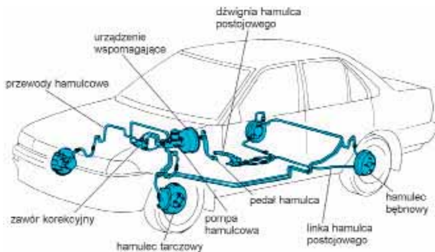
Rys. 1.18 Układ hamulcowy samochodu osobowego [58]
