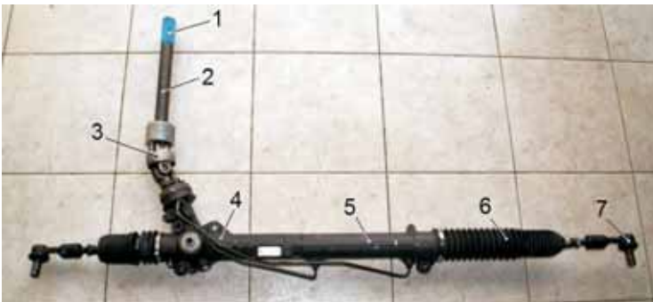
Rys. 5.23 Przekładnia kierownicza zębatkowa wraz z dolnym wałem kierownicy 1 – wielowypust dolnego wału umożliwiający zmianę jego długości, 2 – dolny wał kierownicy, 3 – przegub dwukrzyżakowy, 4 – obudowa przekładni, 5 – cylinder hydraulicznego mechanizmu wspomagania, 6 – gumowa osłona zębatki, 7 – zewnętrzny przegub kulowy bocznego drążka
