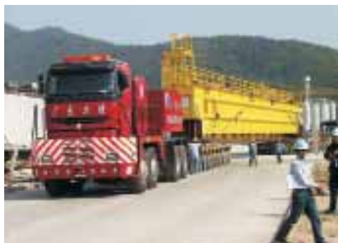
Rys. 1.10 Ciągniki balastowe ze specjalnymi przyczepami do przewozu ładunków ponadgabarytowych [236]
