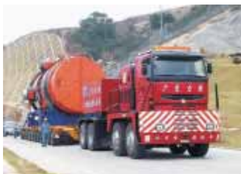
Rys. 1.10 Ciągniki balastowe ze specjalnymi przyczepami do przewozu ładunków ponadgabarytowych [236]
