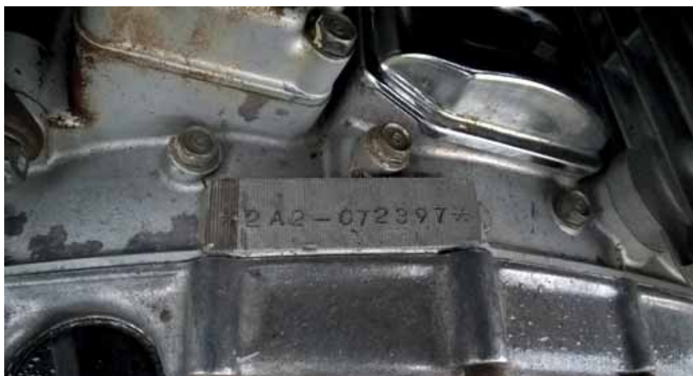
Rys. 1.22 Numer silnika wybity na bloku silnika motocykla Honda CB250
