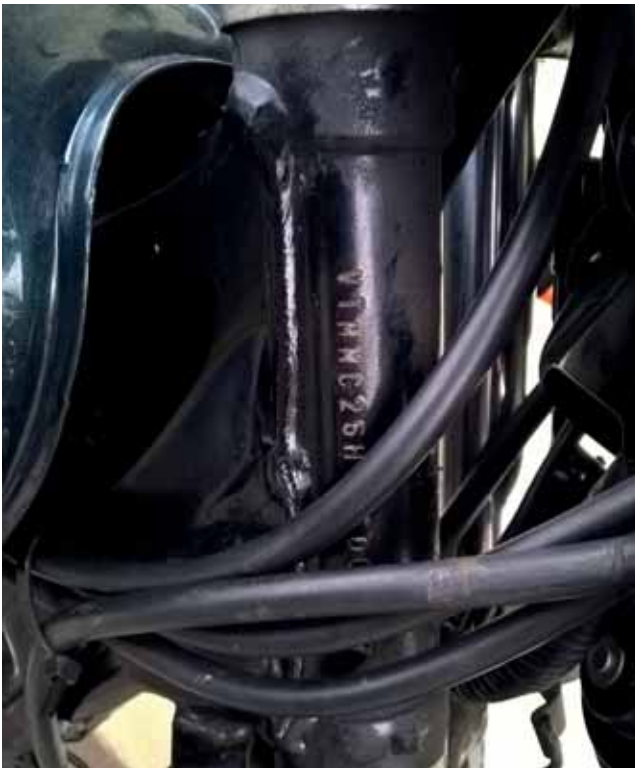
Rys. 1.20 Numer VIN nabyty na główce ramy motocykla Honda CB250
