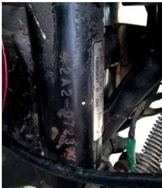
Rys. 1.21 Numer identyfikacyjny ramy starszego typu, nabity na główce ramy motocykla Yamaha XS400
