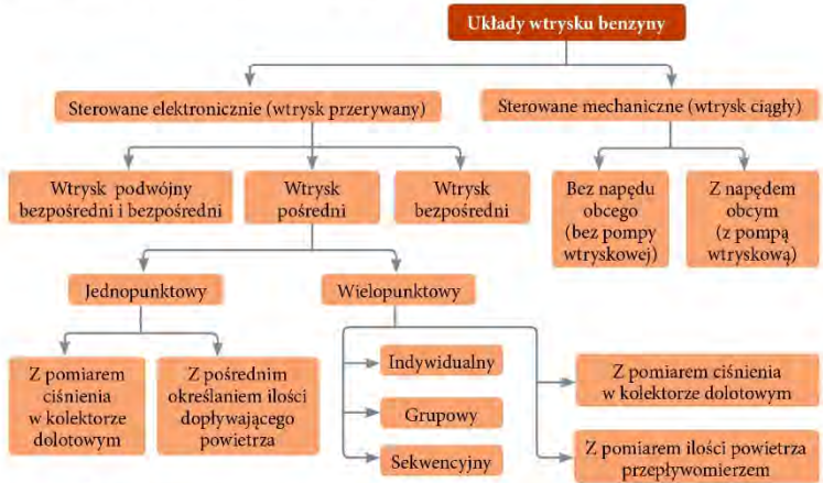
Rys. 4.54 Klasyfikacja układów wtrysku benzyny
