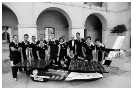
Rys. 10.43. Pojazd słoneczny „Hannibal”. Podczas postoju panele są ustawione optymalnie do Słońca (a), podczas ruchu są ustawione równoległe do powierzchni drogi (b) [Fot. Eduardo Perez Gomez]
