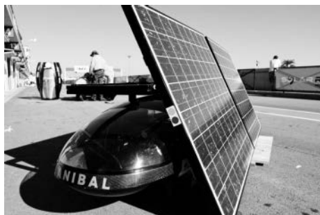
Rys. 10.43. Pojazd słoneczny „Hannibal”. Podczas postoju panele są ustawione optymalnie do Słońca (a), podczas ruchu są ustawione równoległe do powierzchni drogi (b) [Fot. Eduardo Perez Gomez]
