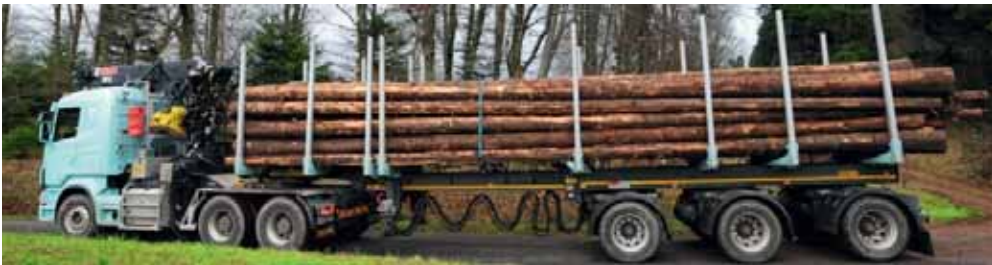
Rys. 1.7 Ciągnik siodłowy z naczepą kłonicową do przewozu długich przedmiotów (np. drewna)
