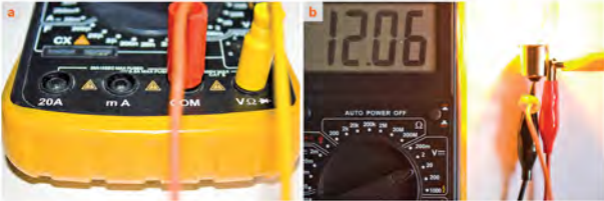
Rys. 2.9 Pomiar napięcia zasilania żarówki 12 V za pomocą multimetru a – sposób podłączenia elektrycznych przewodów pomiarowych do gniazd multimetru, b – pomiar napięcia zasilania żarówki
