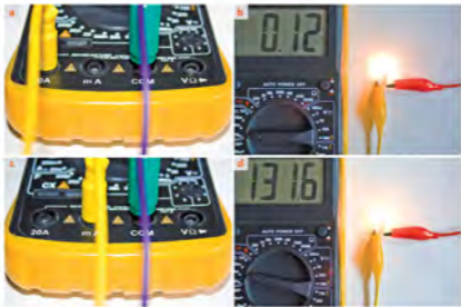
Rys. 2.12 | Pomiary prądu pobieranego przez żarówkę 12 V za pomocą multimetru a - sposób podłączenia przewodów pomiarowych do gniazd multimetru DCA, b - pomiar natężenia prądu stałego na zakresie 20 A DCA, c - sposób podłączenia przewodów pomiarowych do gniazd multimetru DCmA, d - pomiar natężenia prądu stałego na zakresie 200 mA DCmA
