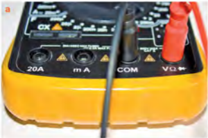
Rys. 2.7 Pomiar ciągłości przewodu za pomocą multimetru a – sposób podłączenia elektrycznych przewodów pomiarowych do gniazd multimetru, b – pomiar ciągłości przewodu
