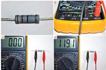
Rys. 2.6 | Pomiary oporu elektrycznego rezystora za pomocą multimetru a - kod paskowy na rezystorze, b - sposób podłączenia elektrycznych przewodów pomiarowych do gniazd multimetru, c - pomiar oporu elektrycznego rezystora o zakresie do 20 MΩ, d - pomiar oporu elektrycznego rezystora o zakresie do 200 Ω
