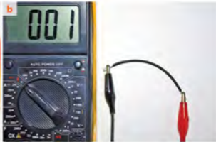
Rys. 2.7 Pomiar ciągłości przewodu za pomocą multimetru a – sposób podłączenia elektrycznych przewodów pomiarowych do gniazd multimetru, b – pomiar ciągłości przewodu
