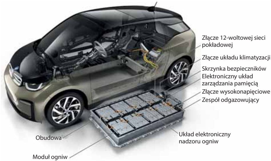
Rys. 14.7. Budowa baterii akumulatorów wysokonapięciowych (litowo-jonowych)
