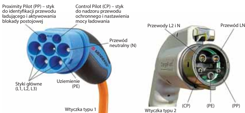
Rys. 14.11. Wtyczki typu 1 i 2. W Europie przeważa typ 2 (źródło: Mennekes, CC BY 2.0 Michael Hicks)
