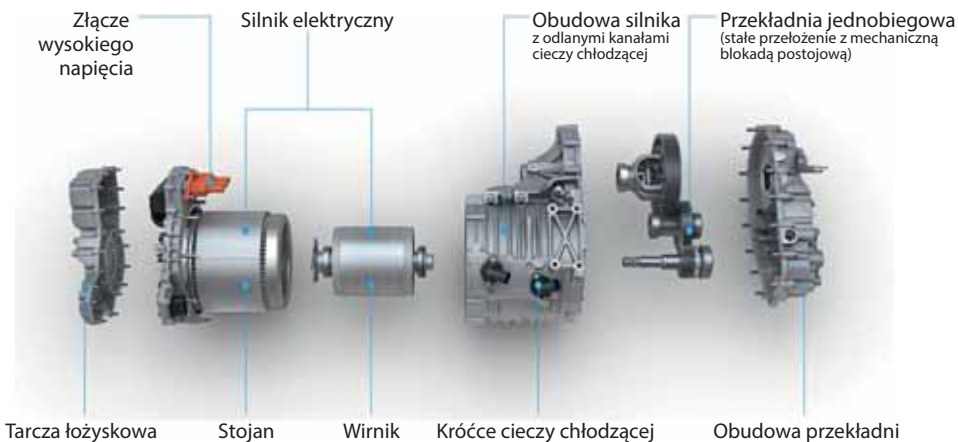
Rys. 14.4. Budowa napędu elektrycznego (źródło: Volkswagen)
