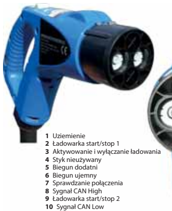
Rys. 14.14. Układ styków we wtyczce CHAdeMO (źródło: Schmidt)
